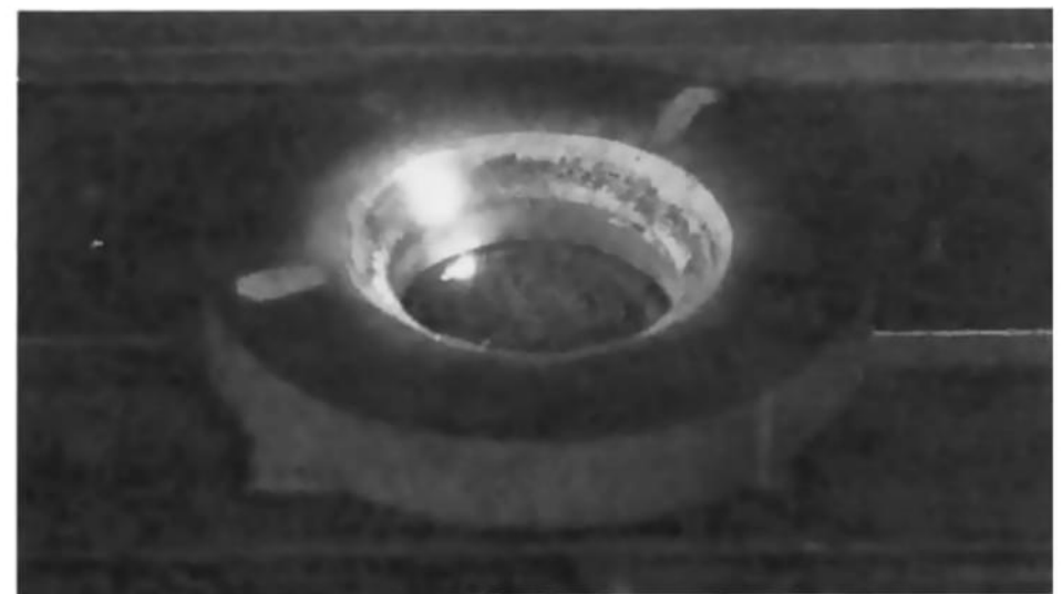
СЕДЛО КЛАПАНА (крупный план). Видна площадка, куда падает лазерный луч, который перемещается автоматически вокруг участка, подлежащего легированию. Материалы, используемые для легирования расплавленного железа, представляют собой порошки. Поскольку лазерный луч не имеет механического контакта с обрабатываемым материалом, положение седла клапана не фиксируется.
