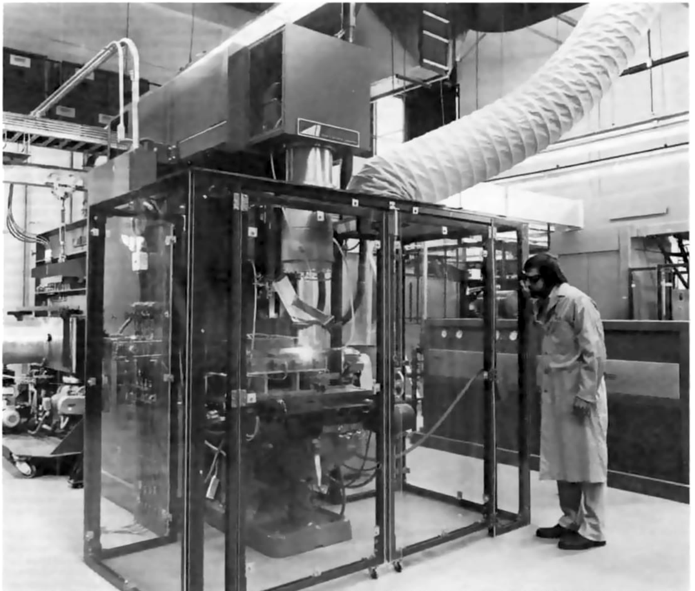
УСТАНОВКА для сварки и резки, а также для закалки поверхности металлических деталей, содержащая лазер мощностью 15 кВт (из первого поколения лазеров, разработанных фирмой Avco Everett). Правая задняя часть установки предназначена для сварки и резки. Проводимая операция — сварка листов нержавеющей стали толщиной 1,25 см со скоростью 62,5 см/мин
